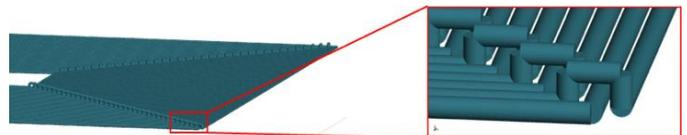
図 1 1 層式オープン型コイルの交差部分
