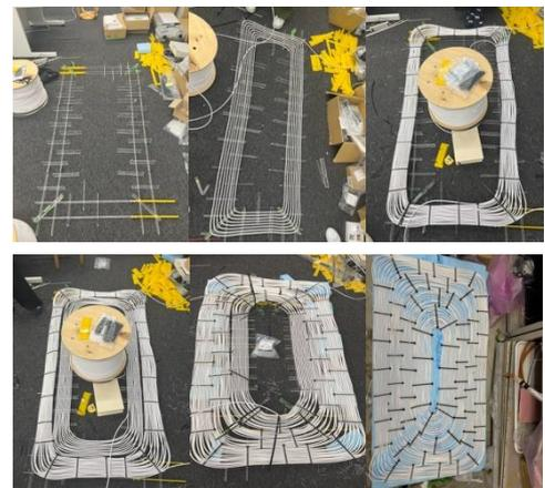
図 3 1 層オープン型ケースレスコイル作りの流れ
